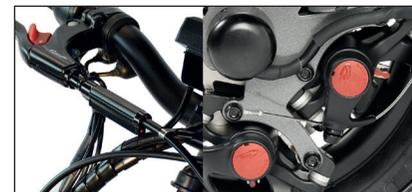
Disco de 140mm, dos frenos mecánicos, dos manetas de aluminio con freno de estacionamiento.
