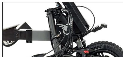
Sistema de plegado para transporte. Chasis regulable en 3 direcciones, ajustable a cada usuario.
