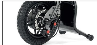
Rueda de 12" con neumático ultra adherente 12" x 2.40" y llanta negra de aluminio fundido.
