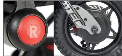
Motor Brushless de 350W nominal, 600W máximo. Velocidad máxima 20 km/h.
