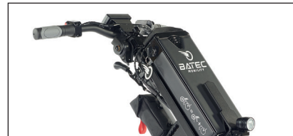
Autonomía de 55 km* con batería de 48v - 748 Wh. Se entrega con cargador 3A ultra- rápido.
