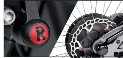
Motor de alta potencia Brushless de 300 RPM 1200 W con marcha atrás. Velocidad máxima 30 km/h.
